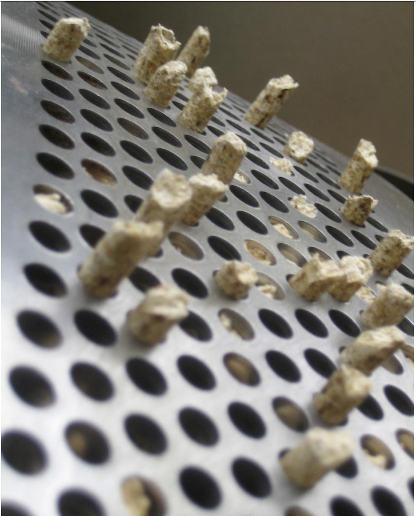
Für die Pelletherstellung werden die Holzreste zunächst getrocknet, zerkleinert und schließlich durch eine Matrize gepresst. Hierbei stellen unterschiedliche Holzarten und
