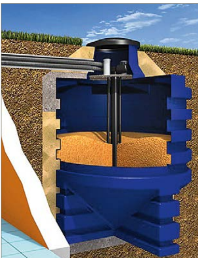
Abb. 17: Erdlager aus Kunststoff mit senkrechter Förderschnecke
